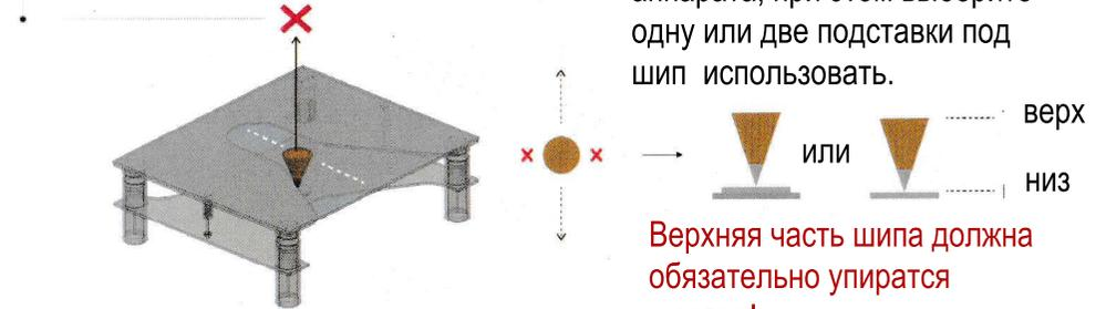
→ Установите шип под центр массы аппарата, при этом выберите одну или две подставки под шип использовать.
