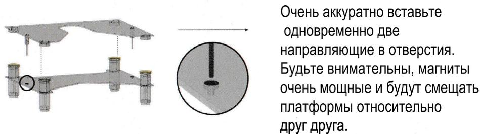
→ Очень аккуратно вставьте одновременно две направляющие в отверстия. Будьте внимательны, магниты очень мощные и будут смещать платформы относительно друг друга.
